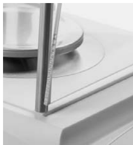
2) Installazione dei pannelli anteriori e posteriori. Inserire l'estremità inferiore nella scanalatura e premere fino al blocco.
