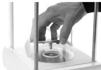
4) Installazione del vassoio
